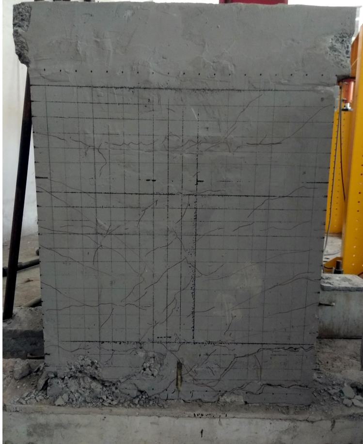
**图6 河南大学结构实验室真实剪力墙试样破坏情况**
